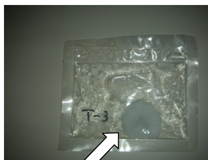
ベンツ型切り込みを持つ試作トリガー(加藤氏製作)と結晶化
