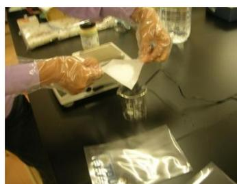
3. 洗浄ビンにいらてある蒸留水 16 ml をメスシリンダーで計り、ビーカーに加える。
